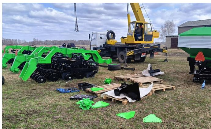
Проверка. Сервисная бригада проверяет корректность работы турбин, электрики, гидравлики, производит поднятие и опускание секций, сборку в транспортное и раскладку в рабочее положение.
