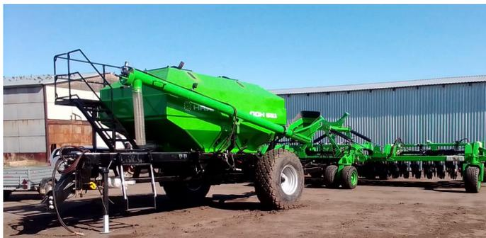
Все настройки производятся вместе с агрономом для того, чтобы посевной комплекс выполнял все необходимые задачи хозяйства правильно и эффективно. Затем делается первый пробный проход, контролируется работа, делается замер глубины посева. Посевной комплекс на 100% готов к работе.
