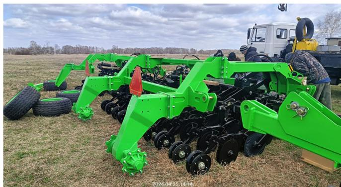
Первым делом производится разгрузка посевного комплекса при помощи крана. Комплекс приходит в 2 грузовых фурах, в первой находятся высевающие секции, во второй бункер и все необходимые комплектующие. Затем делается расстановка секций для максимально удобного процесса сборки, краном производится раскладка в рабочее положение. Процесс разгрузки и подготовки к сборке занимает почти весь рабочий день.
